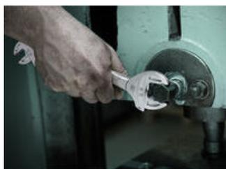
Двусторонний рожковый ключ с самонастройкой Joker 6006 подходит для всех метрических и дюймовых размеров в соответствующем диапазоне применения
