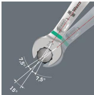
Благодаря наклону на 7,5° рожковой части, профилю в виде двойного шестигранника и оптимальному способу работы (накинуть - завинтить - вернуть - снова накинуть - завинтить - вернуть и т.д.) завинчивать можно в тех случаях, когда для поворота ключом имеется угол меньше 30°.
