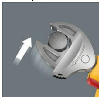
За счёт автоматически плавного смыкания параллельно перемещающихся губок рожковый ключ Joker 6004 VDE подходит для всех размеров в соответствующем диапазоне. Ключ сам и без регулировки выбирает нужный размер при накидывании на гайку или винт.
