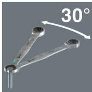
Вместо 60° Joker теперь имеет угол возврата всего 30° и механику двойного шестигранника. Благодаря этому, а также своей прямой головке, Joker избавляет вас от лишних поворотов ключа. С помощью Joker теперь можно вывинчивать, конtring и затягивать болты и гайки в ситуациях, когда беспомощны обычные инструменты. Комбинация упора и малых вращательных углов обеспечивает эффективную работу в том числе на трубных фитингах.
