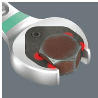
Умная геометрия двойного шестигранника Joker обеспечивает геометрическое замыкание с болтом или гайкой. А сменная, закаленная металлическая пластина в зеве Joker сцепляется очень прочными зубцами в болт. Все это предупреждает неприятное соскальзывание даже при больших моментах затяжки.
