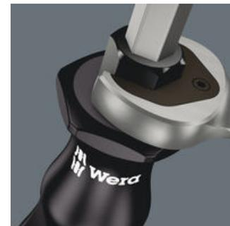
Встроенный вспомогательный шестигранник вместе с гаечным или накидным ключом обеспечивают передачу более высоких крутящих моментов.
