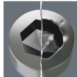
Проблема винтов с внутренним шестигранником состоит в том, что опорные поверхности, передающие усилие с отвертки на винт, очень узкие. Поэтому головка винта может разрушаться. Отвертка с профилем Hex-Plus имеет довольно большую опорную поверхность, которая препятствует этому! Полезно знать: инструменты Hex-Plus подойдут к любому стандартному винту с внутренним шестигранником.
