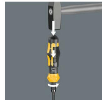
Ударный импульс при включении функции вращения с ударом преобразуется во вращательное движение с моментом силы около 25 Нм. Усилие передаётся без потерь за счёт наличия сквозного стержня.
