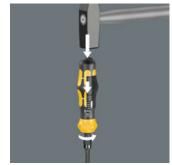
Ударный импульс при включении функции вращения с ударом преобразуется ВО вращательное движение С моментом силы около 25 Нм. Усилие передаётся без потерь за счёт наличия СКВОЗНОГО стержня.
