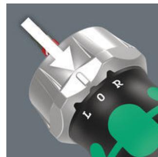
Трещотка с тонким механизмом зацепления для малого угла возврата. С помощью дискового переключателя можно менять направление завинчивания вправо/блокировка/влево. Магнитный битодержатель подходит под шестигранный хвостовик 1/4" по стандарту DIN ISO 1173-C 6,3 и тип хвостовика Wera 1.
