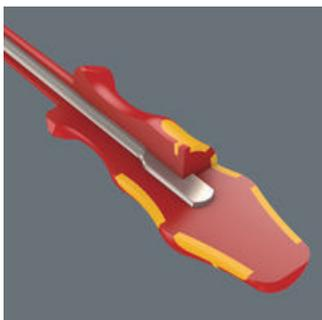
Wera изготавливает ручку Kraftform из нескольких материалов с различными свойствами. Для средней части используется стойкий пластик, который прочно удерживает рабочий конец даже при высоких нагрузках. Для цветных участков применяется более мягкий материал. Материал обладает высокой степенью трения и обеспечивает передачу больших усилий. Черные зоны с более твердыми поверхностями препятствуют прилипанию ручки к ладони. Это позволяет быстро перехватывать отвертку в руке.
