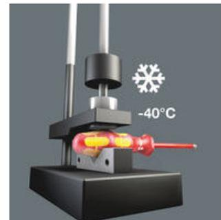
В экстремальных условиях применения безопасность также гарантируется благодаря проверенной ударпрочности при низких температурах -40 °C.
