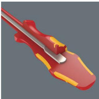
Wera изготавливает ручку Kraftform из нескольких материалов с различными свойствами. Для средней части используется стойкий пластик, который прочно удерживает рабочий конец даже при высоких нагрузках. Для цветных участков применяется более мягкий материал. Материал обладает высокой степенью трения и обеспечивает передачу больших усилий. Черные зоны с более твердыми поверхностями препятствуют прилипанию ручки к ладони. Это позволяет быстро перехватывать отвёртку в руке.
