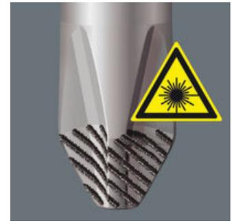
Узко сфокусированный луч лазера создает структуру поверхности с острыми кромками. Наконечник Wera Lasertip крепко "цепляется" за шлиц винта и предотвращает выскальзывание из него. Идеален для прямого шлица, Phillips и Pozidriv.
