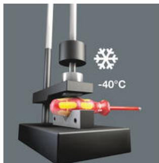
В экстремальных условиях применения безопасность также гарантируется благодаря проверенной ударопрочности при низких температурах -40 °С.
