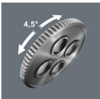
Трещотка Zyklor VDE отличается малым углом возврата всего 4,5° за счёт использования тонкой механики зацепления на 80 зубцов.
