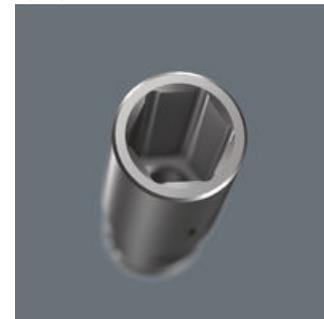
Шестигранный профиль служит для передачи большого усилия и воздействует на грани гайки или головку винта меньше, чем профиль в форме двойного шестигранника. Трещотки с тонким механизмом зацепления также позволяют использовать профиль двойного шестигранника даже в ограниченном пространстве благодаря малому углу возврата.
