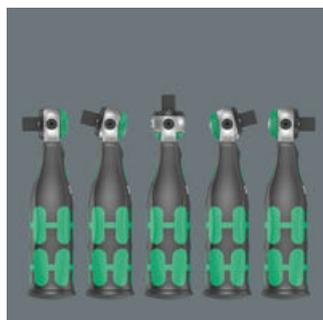
Головка трещотки свободно поворачивается и благодаря расположенным с обеих сторон сдвижным переключателям может блокироваться в любом положении. Таким образом, даже в узких и труднодоступных местах Вы можете выполнять работы без проблем и достаточно свободно. Фиксация в определенных положениях под углом 0°, 15° и 90° влево и вправо гарантирует уверенную работу с надёжно зафиксированной трещоточной головкой.
