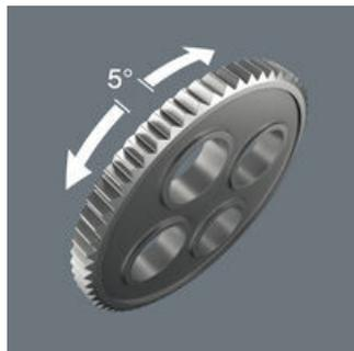
Реверсные трещотки с 72 мелкими зубцами имеют небольшой угол возврата - всего 5°. Небольшой ход трещотки позволяет работать быстро и точно в любых положениях.
