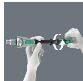
Трещотки Zyklus Speed являются настоящими чемпионами по скорости: Конструкция, использующая инерционную массу, обеспечивает ускорение процесса завинчивания. Вращательно-симметричная конструкция рукоятки Kraftform и муфта свободного хода поддерживают стремительное вращение. В особенности тогда, когда трещотка не входит в зацепление из-за слишком свободной резьбы отвинчиваемой детали.
