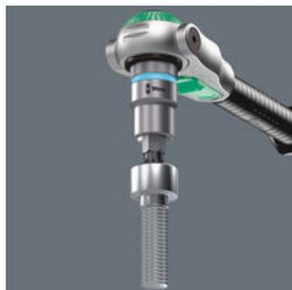
Инструменты TORX® HF, разработанные специалистами Wera, отличаются улучшенной геометрией исходного профиля TORX®. За счет прижимной силы, возникающей в результате контактного давления между наконечником инструмента и профилем головки винта, винты TORX® по спецификации Acument Intellectual Properties надёжно удерживаются на инструменте! Это особенно помогает при работе в труднодоступном месте, куда для поддержки винта не помещается вторая рука.
