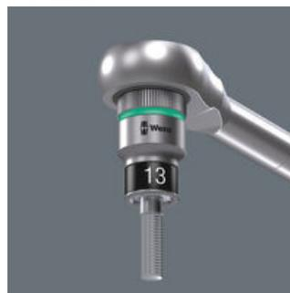
Фиксация шестигранного винта в торцовой головке обеспечивается двумя шариковыми фиксаторами и высокопрочным эластичным воротником. От механического повреждения его защищает стальной буртик, расположенный спереди. Они особенно помогают при работе в труднодоступном месте, куда для поддержки винта не помещается вторая рука.
