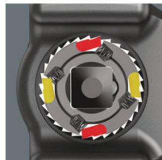
Благодаря двойному храповому механизму 30 прочных зубцов действуют как тонкий механизм из 60 мелких зубцов с углом возврата всего 6°.
