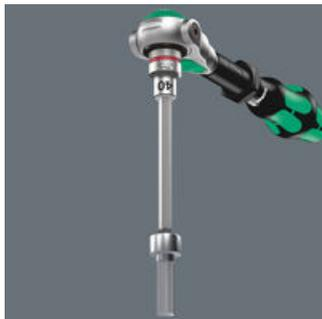
Инструменты TORX® HF, разработанные специалистами Wera, отличаются улучшенной геометрией исходного профиля TORX®. За счет прижимной силы, возникающей в результате контактного давления между наконечником инструмента и профилем головки винта, винты TORX® по спецификации Acument Intellectual Properties надежно удерживаются на инструменте! Это особенно помогает при работе в труднодоступном месте, куда для поддержки винта не помещается вторая рука.
