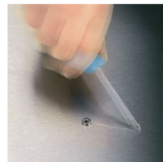
Każdemu przytrafiło się zapewne nie raz, że wkrętak wyslizgnął się z gniazda wkrętu podczas dokręcania bądź odkręcania, powodując czasami uszkodzenia powierzchni montowanego elementu czy wręcz obrażenia użytkownika. Końcówka wkrętaków Wera Lasertip posiada mikroskopijne rowki wypalane promieniem lasera, tworzące chropowatą powierzchnię, która dosłownie "wgryza się" w gniazdo wkrętu. Dzięki temu przypadkowe wyslizgiwanie się z wkrętów to już przeszłość.
