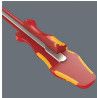
다양한 특성을 지닌 여러 재질을 혼합하여 만드는 Wera의 Kraftform 손잡이. 중간 부분에는 저항상 플라스틱 소재를 사용하여 높은 압력에도 불구하고 블레이드(날)을 안전하게 고정합니다. 색상으로 구분되는 부분은 더 부드러운 재질로 만들어 높은 마찰 저항성 및 토크 전달력을 보장하며 이는 나사 작업에서 비롯되는 작업 피로도를 줄여줍니다. 단단한 표면으로 이루어진 적색 부분은 손이 손잡이에 달라붙는 것을 방지하여 손 위치를 빠르게 재조정할 수 있습니다.
