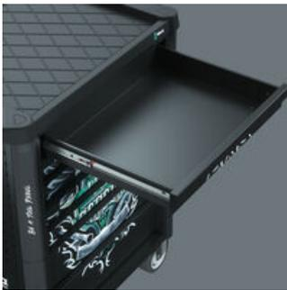
드로워에는 볼 베어링 텔레스코픽 슬라이드가 장착되어 있고 완전히 밖으로 당겨 빼낼 수 있습니다. 자동 닫힘 및 상호 잠금 기능으로 의도치 않게 열리지 않게 방지하므로 워크샵 트롤리에 대해 기울어질 위험이 최소화됩니다. 신중하게 고려된 드로워 디자인은 내부 공간에서 사용하기에 최적화되었습니다. 드로워가 방진 코팅되어 손쉽게 청소할 수 있습니다.
