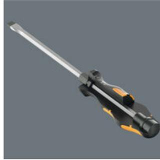
치즐드라이버는 단순한 스크루드라이빙 이상의 작업을 위한 솔루션임. 고정된 나사나 호스 클램프를 고정, 치즐링, 푸는 데 사용됨. 통합된 임팩트 캡을 통해 서비스 수명을 늘리고 깨질 위험을 줄임. 망치로 때려도 큰 힘의 손실 없이 전달되는 고급 재질로 만든 파운드 스루 육각 블레이드 포함. 블레이드가 깨지거나 부서지지 않게 보호하는 단단한 점성 강화 재질. 통합된 육각 볼스터에 오픈 조 또는 링 스패너를 부착하면 더 큰 토크를 전달할 수 있음.
