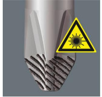
정확하게 초점을 맞춘 레이저는 날카로운 표면 구조를 만들어냅니다. 이 레이저 처리 방식을 활용 시 가장자리 경도는 최대 1000 HV 0.3입니다. Wera의 레이저팁 기술을 통해 정확한 나사 체결이 가능하며 미끄러짐을 방지합니다. 일자, 필립스, 포지드리브 나사용 스크루드라이버에 적용 가능합니다.
