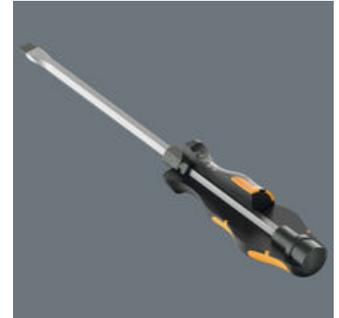
치즐드라이버는 단순한 스크류드라이빙 이상의 작업을 위한 솔루션임. 고정된 나사나 호스 클램프를 고정, 치즐링, 푸는 데 사용됨. 통합된 임팩트 캡을 통해 서비스 수명을 늘리고 깨질 위험을 줄임. 망치로 때려도 큰 힘의 손실 없이 전달되는 고급 재질로 만든 파운드 스루 육각 블레이드 포함. 블레이드가 깨지거나 부서지지 않게 보호하는 단단한 점성 강화 재질. 통합된 육각 볼스터에 오픈 조 또는 링 스패너를 부착하면 더 큰 토크를 전달할 수 있음.
