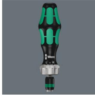
라쳇 스크류드라이버, 낮은 역회전 각도를 위한 미세 톱니 디자인 적용, 라쳇(방향조정) 링을 조절하여 오른쪽, 왼쪽 방향 라쳇 기능 탑재, 일반 드라이버처럼 고정식으로도 사용 가능, 최대 토크 50 NM, 신속한 탈부착, 커버의 빠른 회전, 한 손 작업을 용이케 하는 Rapidaptor 기술을 적용한 1/4" 육각 척(물림쇠), 자성, DIN ISO 1173-C 6.3 & E 6.3 및 Wera 시리즈 1, 4에 따라 제조된 육각 소켓 인서트 비트에 적합.
