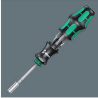
Kraftform Kompakt 28 시리즈의 세트는 특별합니다. 2단 길이로 조절 가능한 블레이드는 좁은 공간에서 작업 시 손잡이 안으로 넣어 짧게 조정하거나 넓은 공간에 맞게 확장하여 사용할 수 있습니다. 아예 손잡이에서 빼내 전동 공구의 100mm 비트 홀더로도 사용 가능합니다. 비트 6종이 누름 버튼으로 쉽게 열 수 있는 탄창(비트창)에 들어있습니다.
