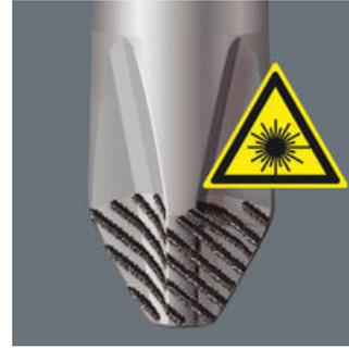
정확하게 초점을 맞춘 레이저는 날카로운 표면 구조를 만들어냅니다. 이 레이저 처리 방식을 활용 시 가장자리 경도는 최대 1000 HV 0.3입니다. Wera의 레이저팁 기술을 통해 정확한 나사 체결이 가능하며 미끄러짐을 방지합니다. 일자, 필립스, 포지드립 나사용 스크류드라이버에 적용 가능합니다.
