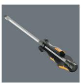
치즐드라이버는 단순한 스크루드라이빙 이상의 작업을 위한 솔루션임. 고정된 나사나 호스 클램프를 고정, 치즐링, 푸는 데 사용됨. 통합된 임팩트 통해 서비스 수명을 캡을 늘리고 깨질 위험을 망치로 때려도 큰 힘의 손실 없이 전달되는 고급 재질로 만든 파운드 스루 블레이드 포함. 블레이드가 부서지지 깨지거나 않게 보호하는 단단한 점성 강화 재질. 통합된 육각 볼스터에 오픈 조 또는 링 스패너를 부착하면 더 큰 토크를 전달할 수 있음.
