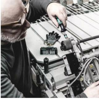
조립 및 유지보수 작업 시 쓰이는 수많은 나사는 확실한 나사 체결을 보장하고 나사 또는 작업물 손상을 방지하기 위해 제어된 토크로 조여야 합니다. 이러한 조건을 충족하는 공구는 바로 Wera의 토크 조정 가능한 스크류드라이버입니다. 0.3Nm ~ 8.8Nm의 토크 범위, 각각 다른 손잡이 2종, ±6%의 측정 정확도, 빠른 비트 변경을 위한 Rapidaptor 기술을 적용하였습니다.
