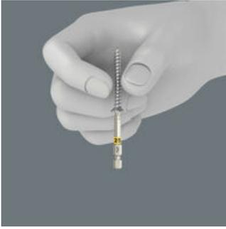
엔진실 등 좁은 조립 및 분해 작업공간에서는 손으로 나사를 안전하게 고정하는 것이 불가하여 나사가 미끄러져 분실되는 경우가 허다합니다. 나사를 찾는 시간이 길어지고 분실과 관련하여 위험한 상황이 발생할 수 있습니다. 이런 상황에서 본래 별(독스) 팁의 구조를 최적화한 Wera의 HF 공구를 사용하기에 특히 적합합니다. 드라이브 팁(끝부분)형상과 나사 팁 사이에서 접지압이 발생하면, 썩기 작용으로 나사를 확실히 고정합니다.
