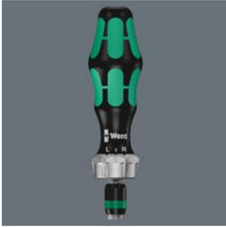
라쳇 스크류드라이버, 낮은 역회전 각도를 위한 미세 톱니 디자인 적용, 라쳇(방향조정) 링을 조절하여 오른쪽, 왼쪽 방향 라쳇 기능 탑재, 일반 드라이버처럼 고정식으로도 사용 가능, 최대 토크 50 NM, 신속한 탈부착, 커버의 빠른 회전, 한 손 작업을 용이케 하는 Rapidaptor 기술을 적용한 1/4" 육각 척(몰림쇠), 자성, DIN ISO 1173-C 6.3 & E 6.3 및 Wera 시리즈 1, 4에 따라 제조된 육각 소켓 인서트 비트에 적합.
