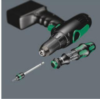
Kraftform Kompakt 20 시리즈의 세트는 특별합니다. 2단 길이로 조절 가능한 블레이드는 좁은 공간에서 작업 시 손잡이 안으로 넣어 짧게 조정하거나 넓은 공간에 맞게 확장하여 사용할 수 있습니다. 아예 손잡이에서 빼내 전동 공구의 100mm 비트 홀더로도 사용 가능합니다. 비트 6종이 누름 버튼으로 쉽게 열 수 있는 탄창(비트창)에 들어있습니다. 자유로이 회전하는 커버를 적용한 Rapidaptor 기술을 통해 전동 공구 사용 시 한 손만으로 비트를 교체할 수 있으며 압입 자동 비트 잠금 및 안전한 포지셔닝을 보장합니다.
