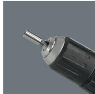
1/4" 외부 육각 드라이브로 비트 장착하기 위한 범용 홀더. 뛰어난 내부식성을 위한 스테인리스강 슬리브 고정 링으로 공구를 홀더에 최적으로 맞게 확실하게 고정할 수 있음. 강력한 영구 자석이 비트를 단단하게 고정함. DIN ISO 1173-F 6.3 규격 장착부의 스크루드라이버 머신에 적합함.
