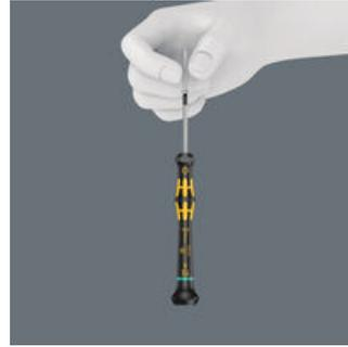
엔진실 등 좁은 조립 및 분해 작업공간에서는 손으로 나사를 안전하게 고정하는 것이 불가하여 나사가 미끄러져 분실되는 경우가 허다함. 나사를 찾는 시간이 길어지고 분실과 관련하여 위험한 상황이 발생할 수 있음. 이런 상황에서 본래 별(특스) 팁의 구조를 최적화한 Wera의 HF 공구를 사용하기에 특히 적합. 드라이브 팁(끝부분)형상과 나사 팁 사이에서 접지압이 발생하면, 썩기 작용으로 나사를 확실히 고정함.
