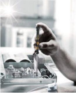
전자제품 수리 관련 나사 작업 시(예시: 스마트폰, 태블릿PC 등) 오작동 및 고장을 일으킬 수 있는 정전기가 나지 않게 해야합니다. 하여 정전기 발생을 방지하는 공구가 필수적으로 필요합니다.
