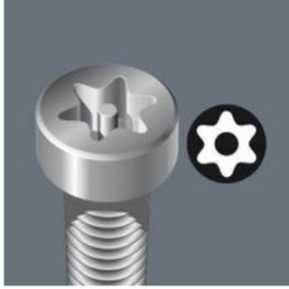
별(특스) 공구에 뚫린 천공은 안전 나사가 무단으로 풀리는 것을 방지합니다. 나사의 드라이브 팁(끝부분) 형상에 돌출핀을 탑재하여 일반 별(특스) 공구를 사용할 수 없습니다. 이 핀은 별(특스) BO 공구의 천공에 딱 맞아 안전 나사가 풀릴 수 있도록 합니다.
