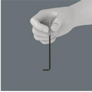
엔진실 등 좁은 조립 및 분해 작업공간에서는 손으로 나사를 안전히 고정하는 것이 불가하여 나사가 미끄러져 분실되는 경우가 허다함. 나사를 찾는 시간이 길어지고 분실과 관련하여 위험한 상황이 발생할 수 있음. 이런 상황에서 본래 별(특스) 팁의 구조를 최적화한 Wera의 HF 공구를 사용하기에 특히 적합. 드라이브 팁(끝부분)형상과 나사 팁 사이에서 접지압이 발생하면, 썩기 작용으로 나사를 확실히 고정함.
