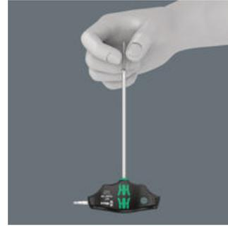
엔진실 등 좁은 조립 및 분해 작업공간에서는 손으로 나사를 안전하게 고정하는 것이 불가하여 나사가 미끄러져 분실되는 경우가 허다함. 나사를 찾는 시간이 길어지고 분실과 관련하여 위험한 상황이 발생할 수 있음. 이런 상황에서 본래 별(특스) 팁의 구조를 최적화한 Wera의 HF 공구를 사용하기에 특히 적합. 드라이브 팁(끝부분)형상과 나사 팁 사이에서 접지압이 발생하면, 썩기 작용으로 나사를 확실하게 고정함.
