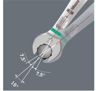
15°도 상향 조정된 입구 부분, 이중 육각 구조 및 조정 가능한 적용 방법(배치, 조이기, 돌리기, 재배치, 조이기, 돌리기 등)으로 30°상향 조정된 각도에서도 나사 작업 수행 가능.
