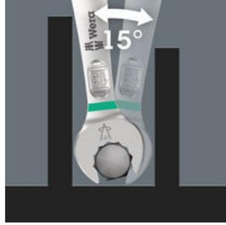
조커 6003 콤비네이션 렌치는 7.5°로 상향 조정된 입구 구조와 이중 육각 구조를 통해 세로 축을 중심으로 180° 반복적으로 렌치를 돌릴 시 배치 지점을 두 배 확보합니다. 볼트 및 나사 머리는 15 도달 시 맞물립니다. 돌릴 때마다 자동으로 각 배치 지점을 찾는 조커 6003.
