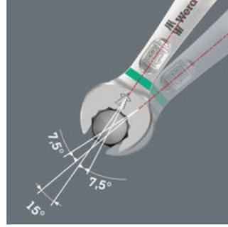
15°도 상향 조정된 입구 부분, 이중 육각 구조 및 조정 가능한 적용 방법(배치, 조이기, 돌리기, 재배치, 조이기, 돌리기 등)으로 30°상향 조정된 각도에서도 나사 작업 수행 가능.
