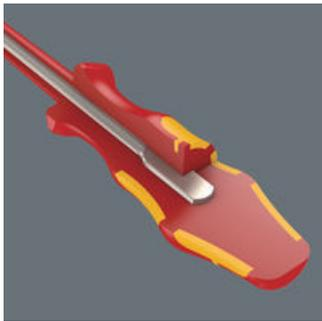
다양한 특성을 지닌 여러 재질을 혼합하여 만드는 Wera의 Kraftform 손잡이. 중간 부분에는 저항성 플라스틱 소재를 사용하여 높은 압력에도 불구하고 블레이드(날)을 안전하게 고정합니다. 색상으로 구분되는 부분은 더 부드러운 재질로 만들어 높은 마찰 저항성 및 토크 전달력을 보장하며 이는 나사 작업에서 비롯되는 작업 피로도를 줄여줍니다. 단단한 표면으로 이루어진 적색 부분은 손이 손잡이에 달라붙는 것을 방지하여 손 위치를 빠르게 재조정할 수 있습니다.
