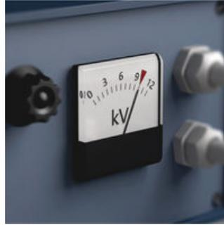
10,000V에서 공구의 유전 강도 테스트를 통해 공구의 가장 중요한 특성인 절연을 테스트했기 때문에 사용자는 안심하고 사용할 수 있음. Wera VDE 공구는 최대 1,000V에서도 안전한 작동을 보장해주는 이 테스트를 개별적으로 거쳐야 함.
