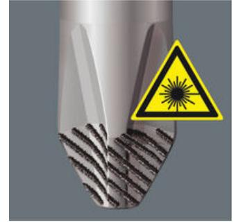
정확하게 초점을 맞춘 레이저는 날카로운 표면 구조를 만들어냅니다. 이 레이저 처리 방식을 활용 시 가장자리 경도는 최대 1000 HV 0.3입니다. Wera의 레이저팁 기술을 통해 정확한 나사 체결이 가능하며 미끄러짐을 방지합니다. 일자, 필립스, 포지드립 나사용 스크류드라이버에 적용 가능합니다.
