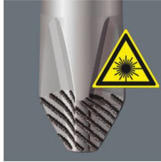
정확하게 초점을 맞춘 레이저는 날카로운 표면 구조를 만들어냅니다. 이 레이저 처리 방식을 활용 시 가장자리 경도는 최대 1000 HV 0.3입니다. Wera의 레이저팁 기술을 통해 정확한 나사 체결이 가능하며 미끄러짐을 방지합니다. 일자, 필립스, 포지드립브 나사용 스크류드라이버에 적용 가능합니다.
