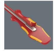
다양한 지닌 특성을 혼합하여 만드는 재질을 Wera의 Kraftform 손잡이. 중간 부분에는 저항상 플라스틱 소재를 사용하여 높은 압력에도 불구하고 블레이드(날)을 안전하게 고정합니다. 색상으로 구분되는 부분은 더 부드러운 재질로 만들어 높은 마찰 및 토크 전달력을 저항성 보장하며 이는 나사 작업에서 작업 비롯되는 피로도를 줄여줍니다. 단단한 표면으로 이루어진 적색 부분은 손이 달라붙는 것을 손잡이에 방지하여 손 위치를 빠르게 재조정할 수 있습니다.
