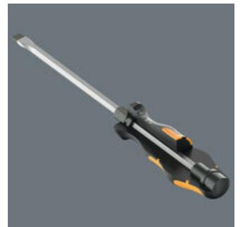
치즐드라이버는 단순한 스크류드라이빙 이상의 작업을 위한 솔루션임. 고정된 나사나 호스 클램프를 고정, 치즐링, 푸는 데 사용됨. 통합된 임팩트 캡을 통해 서비스 수명을 늘리고 깨질 위험을 줄임. 망치로 때려도 큰 힘의 손실 없이 전달되는 고급 재료로 만든 파운드 스루 육각 블레이드 포함. 블레이드가 깨지거나 부서지지 않게 보호하는 단단한 점성 강화 재질. 통합된 육각 볼스터에 오픈 조 또는 링 스패너를 부착하면 더 큰 토크를 전달할 수 있음.
