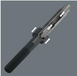
4가지 나사 크기로 작업할 수 있으며 4-in-1 비트 9506 및 9507이 포함되어 있습니다. 4가지 크기의 육각 소켓 나사(3.0, 4.0, 5.0, 6.0)용 4-in-1 비트 9506, 3가지 크기의 육각 소켓 나사(2.5, 5.0, 6.0) 및 한 가지 크기의 TORX® 나사(TX 25)용 4-in-1 비트 9507. 더 큰 프로파일을 사용하기 위해서는 스프링 장력을 계속해서 누르면서 스크루드라이빙을 해야 합니다. 그래야 더 작은 프로파일이 카운터싱크되고 더 큰 프로파일이 사용될 수 있습니다.
