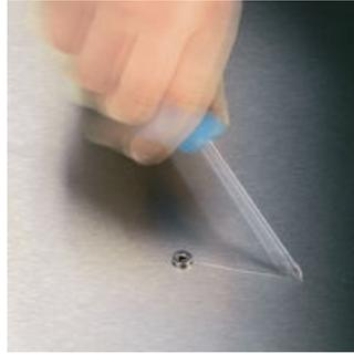
ネジ締め作業時に、ネジ頭からドライバーの先端が滑り落ちてしまうことが度々あります。工具、材質ともに傷つけてしまう可能性があります。ヴェラのレーザー加工が施された先端はギザが刻まれたようになっていて、これがネジ頭に"食いつき"滑り落ちる事(カムアウト)を防ぎます。カムアウト現象は今や過去のものとなりました。
